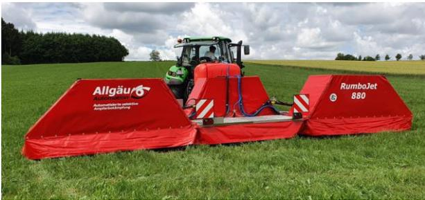
Auf Dauergrünland sind Flächenspritzungen seit diesem Jahr nicht mehr erlaubt. Der RumboJet ist jedoch die Lösung. Das Gerät erkennt mithilfe Kameras die Ampferpflanzen und besprüht diese durch einzeln geschaltete Düsen gezielt mit Pflanzenschutzmittel. Das gilt rechtlich als Einzelpflanzenbekämpfung, die weiterhin erlaubt ist.
